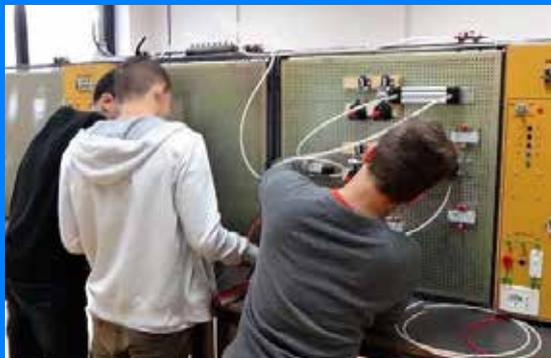
*“Le nostre lezioni delle materie di indirizzo si svolgono prevalentemente in laboratorio e sono incentrate nell’utilizzo di PLC Siemens. Vi chiederete di cosa si tratta...non è altro che un computer per l’industria specializzata nella gestione e nel controllo dei processi industriali e noi lo utilizziamo per la progettazione e realizzazione di automatismi elettrici ed elettropneumatici. Venite a provarlo voi stessi...”*
